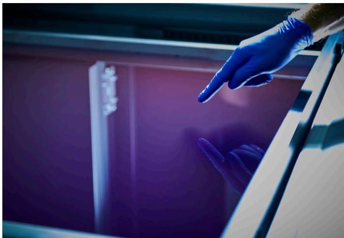
Projetada com um sistema de resina aberta, oferece aos clientes a possibilidade de utilizar qualquer produto disponível comercialmente Resina química híbrida de 355 nm.
